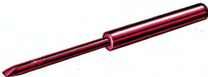
Destornilladores especiales para ajuste de bobinas con núcleo deslizante.
