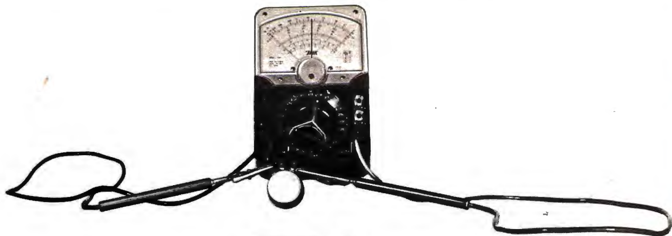
Potenciómetro correcto. Lectura aproximada, 500 K\Omega .
