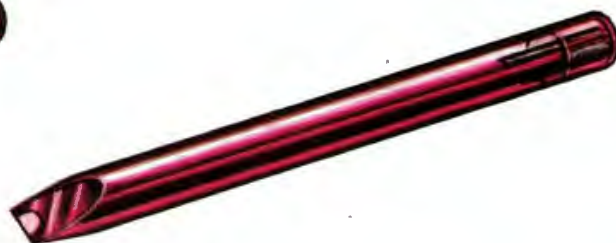
Destornilladores especiales para ajuste de bobinas con núcleo deslizante.
